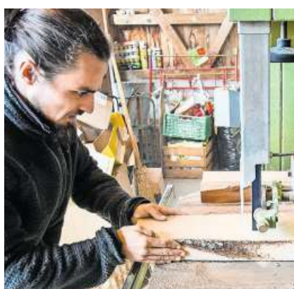
Der Herstellungsprozess von Blockflöten ist aufwendig. Er beginnt mit Grobarbeit und endet mit feinen Justierungen. In der Werkstatt wird als Erstes das Holz rechtgesägt.
