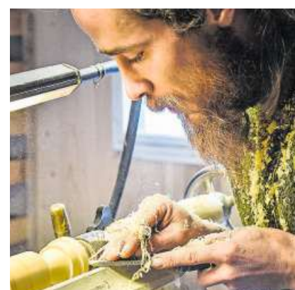
Dieser Arbeitsschritt an der Drechselbank hat kaum Einfluss auf den Ton des Instruments, er dient der Zierde. Die Gebrüder Meyer legen Wert darauf, dass die Flöten genauso edel aussehen, wie sie klingen.
